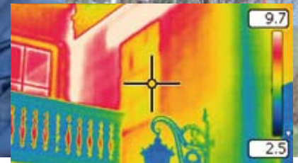
Ein ehemaliges Fenster - mit Backsteinen oder Putz in besserer Qualität zugemauert
