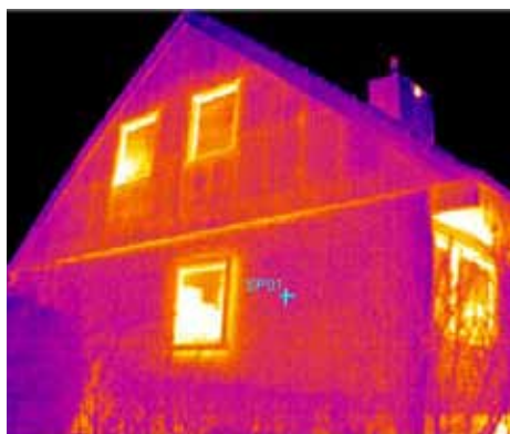
Dieses Wärmebild zeigt beispielhaft die mangelhafte Dämmung eines Wohnhauses.
