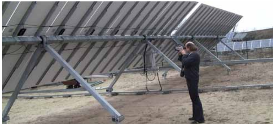
Volker Denzler, Thermografieexperte der SOLON Kundendienstabteilung, nimmt Wärmebilder von der Rückseite eines Moduls auf, um Reflexionen zu vermeiden.
