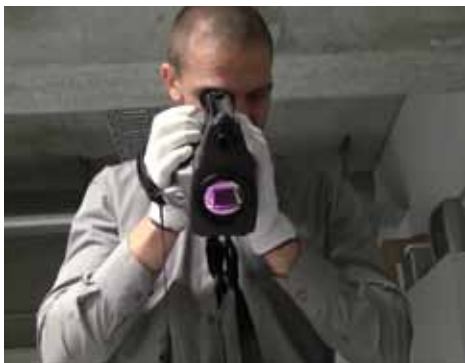
Oliver Frank, Teamleiter der F&E-Abteilung bei SOLON, überprüft mit einer FLIR-Wärmebildkamera den Parallelwiderstand von Solarzellen.
