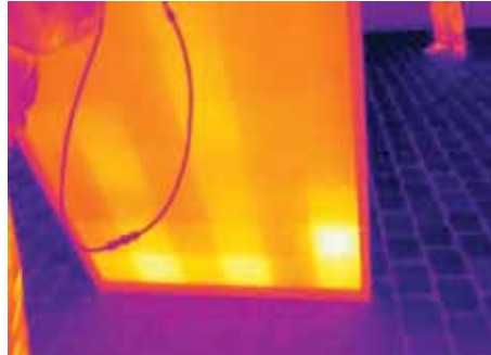
Diese von der Rückseite desselben Solarmoduls aufgenommenen Bilder zeigen deutlich weniger Reflexionen als die Aufnahmen von vorne und lassen dadurch wesentlich exaktere Temperaturmessungen zu.
