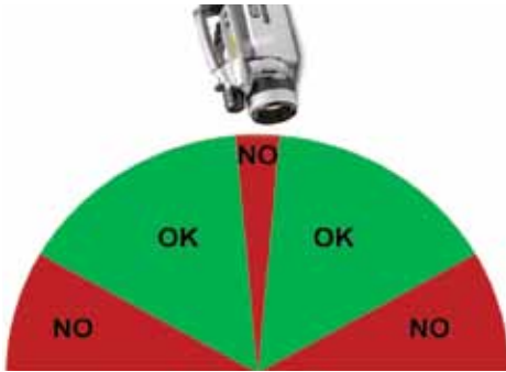
Empfohlener (grün) bzw. ungünstiger (rot) Betrachtungswinkel bei thermografischen Untersuchungen.
