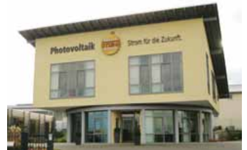
Alle zehn Minuten bewegt sich die obere Etage des Bürogebäudes von Solartechnik Stiens in Kaufungen fast unmerklich, um die Solarmodule auf dem Dach nach der Sonne auszurichten.
