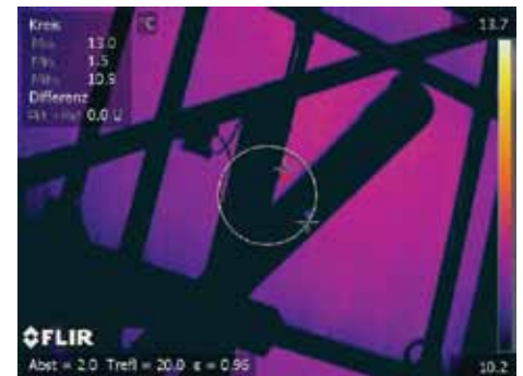
Die heißen Stellen auf diesem Wärmebild, das von der Vorderseite des Solarmoduls aufgenommen wurde, könnten ein Anzeichen dafür sein, dass eine Vielzahl von Zellen ineffizient arbeitet.
