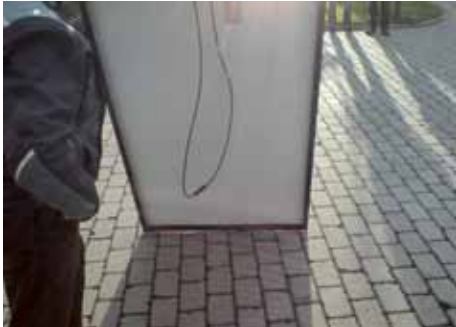
Diese von der Rückseite desselben Solarmoduls aufgenommenen Bilder zeigen deutlich weniger Reflexionen als die Aufnahmen von vorne und lassen dadurch wesentlich exaktere Temperaturmessungen zu.
