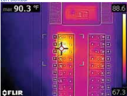
Bereichsfeld mit Hot-Spot-Anzeige macht aktive elektrische Sicherung sichtbar
