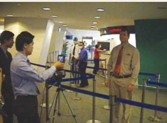
Einrichtung einer FLIR Infrarotkamera mit automatischer Temperaturkompensation (ATC) zur Erkennung von Viruserkrankungen.
